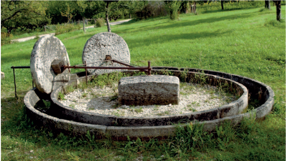
Obstpresse von 1800. Der Antrieb erfolgte durch Kühe oder Ochsen (Freilichtmuseum Beuren).
