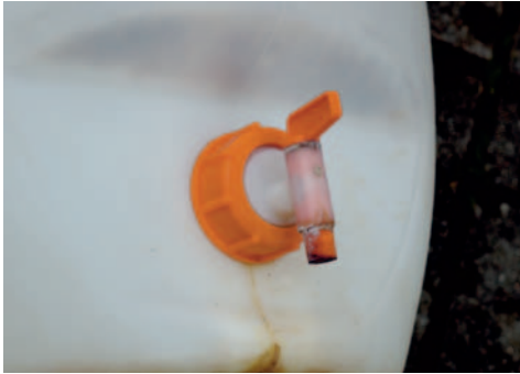
Verunreinigter Ablaufhahn am Kunststofffass.
