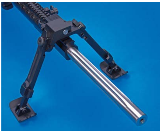
Das Fortmeier Zweibein, unter und über der Waffe montiert. Bei letzterer Montage-Anordnung erhält man ein verbessertes Rückstoßverhalten, weil die Laufseelenachse unter dem Auflagepunkt liegt.
