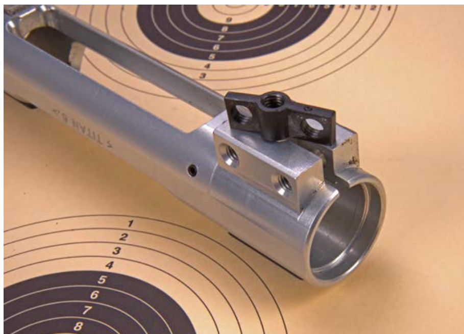
Dieser Gewindeinsatz im geschlitzten Rückstoßblock dient als Verbindungselement zwischen System und Schaft.
