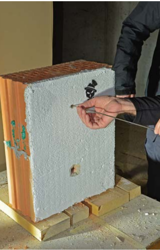
Selbst mit der relativ starken 5,56x45 Munition konnte bei dem mit Hohlkammern versehenen Porotonziegel kein Durchschuss erzielt werden.
