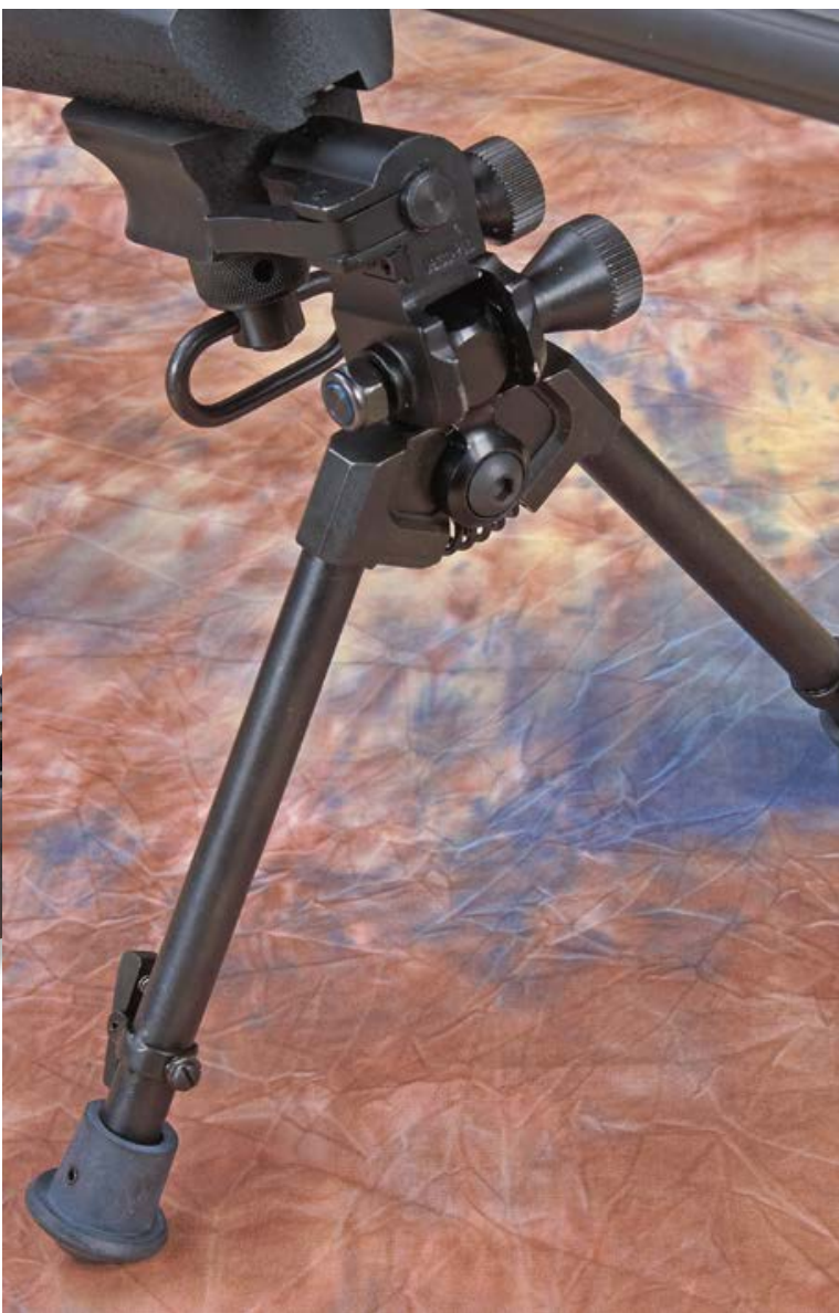
In der ISSF-Metallschiene an der Vorderschaft-Unterseite wurde das Zweibein montiert.
