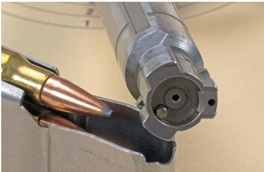
Die drei paarweise hintereinander angeordneten Warzen bilden eine große Anlagefläche im Lauf.
