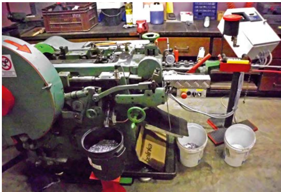
Die Geschosse werden aus dem angelieferten Bleidraht gepresst.
