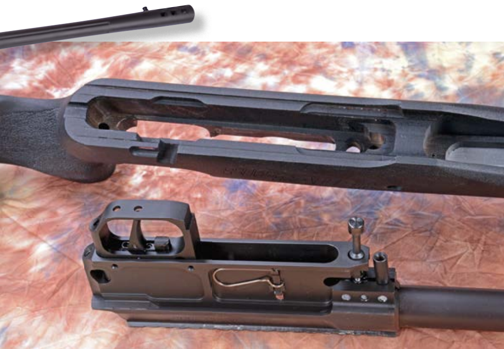
Toleranzarme Systembettung der SIG Sauer SSG 3000 Target.
