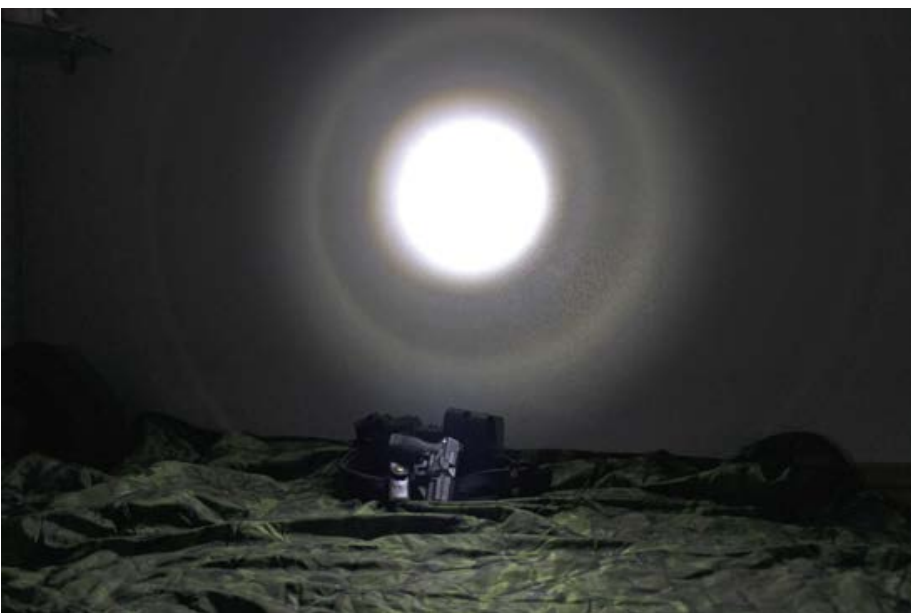
So soll es nicht sein: Fokussierbare Lampen mit Schatten im Spot oder Schattenringen.
