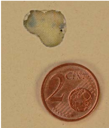
Topstreukreis von 8 mm auf 100 Meter mit MEN 168 Grains MEN HPBT Fabrikmunition.
