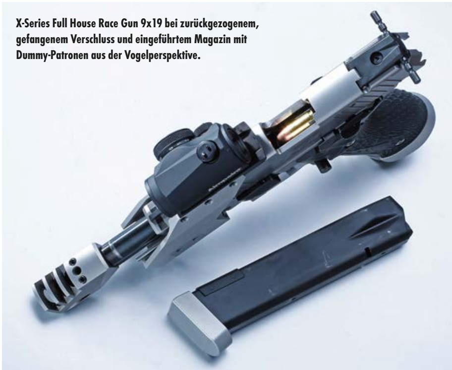
Massivbauweise der Griffstückmontage zur Aufnahme des Leuchtpunktvisiers.
