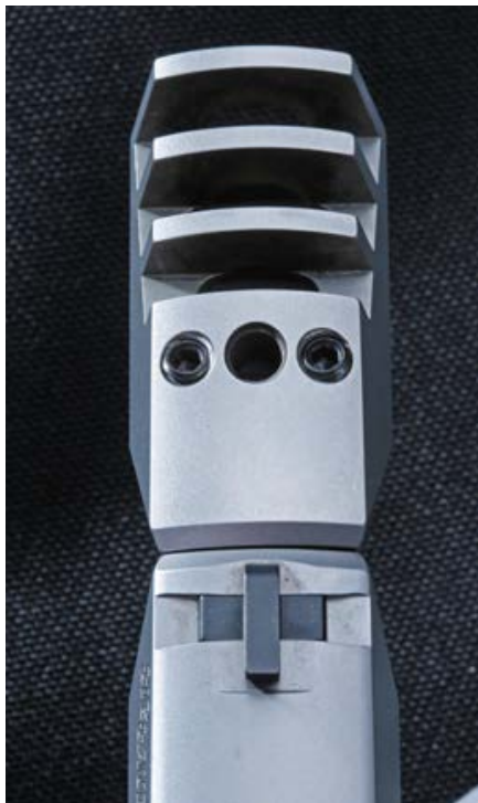
Blick auf den verstellbaren Drei-Kammer-Kompensator mit markantem Profil.
