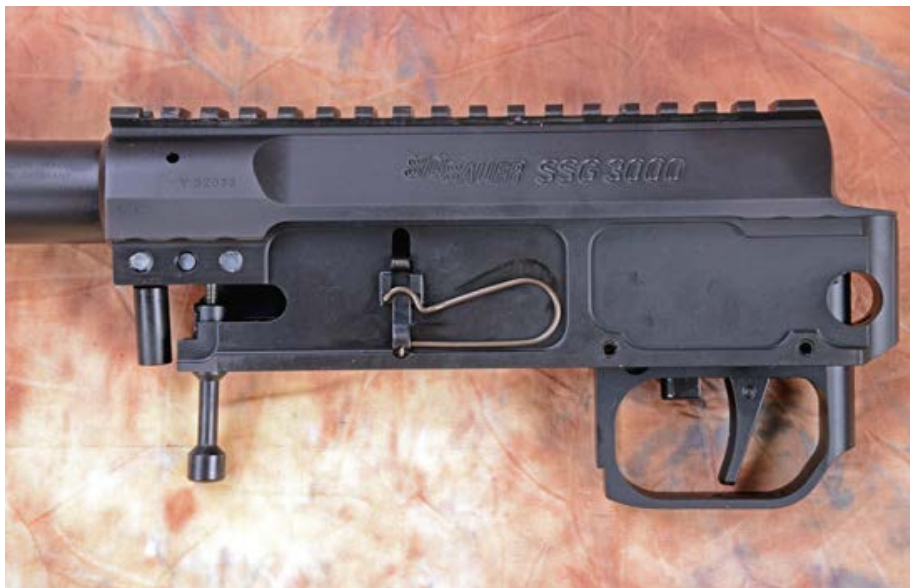
Markanter Systemkasten mit seinen drei Klemmschrauben für die Laufarretierung in beiden Seitenansichten.
