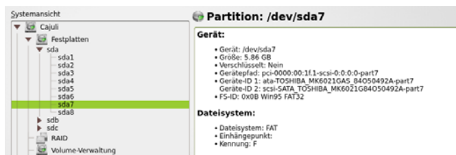
Abb. 6.54 Anzeige der Partitionen über YaST → System → Partitionierer
