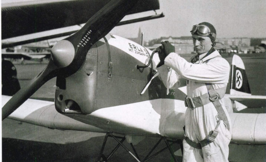
Zum Anlassen musste gekurbelt werden. Einen E-Starter besaß der Zündapp nicht.
