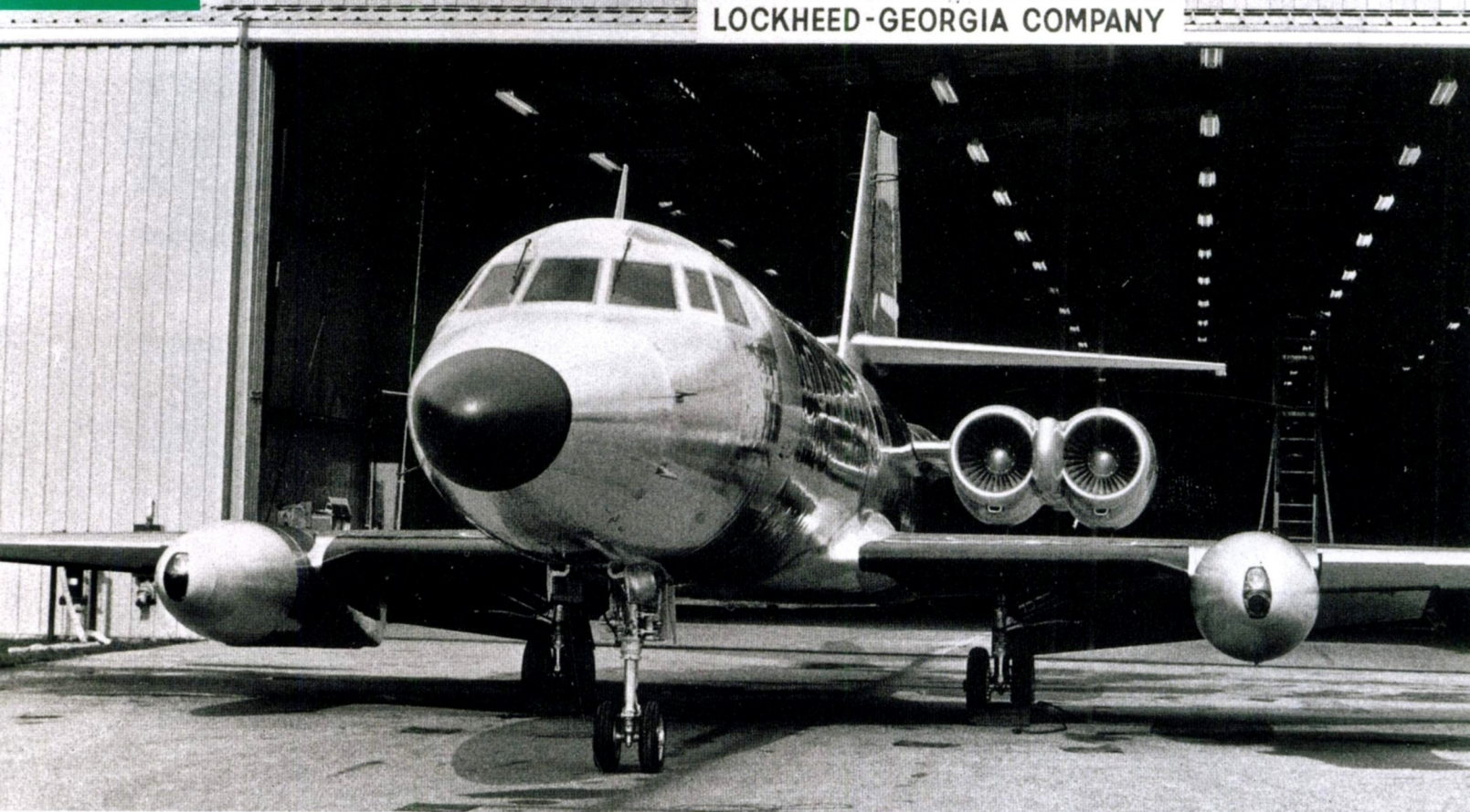
Roll-out des JetStar II am 30. Juni 1976 in Mariette (oben). Die Flügeltanks dieser Version schlossen bündig mit der Flügeloberseite ab.
