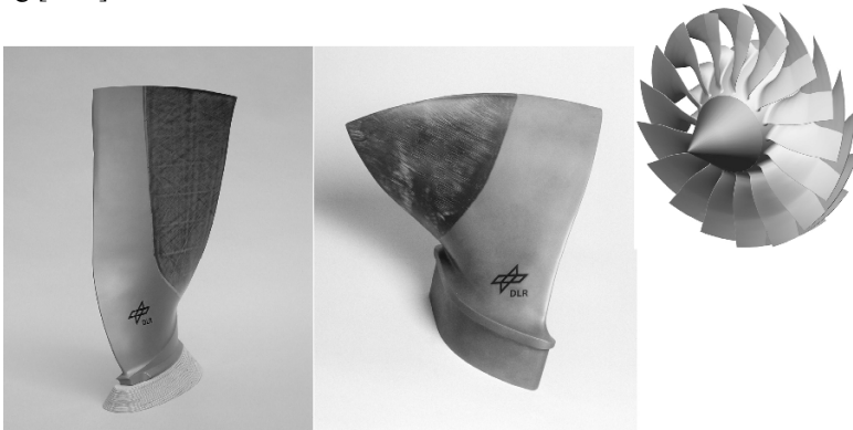
Abb. 24.2. Verdichterschaukeln aus Ti6Al-4V und CF-PEEK (Quelle: DLR, Stuttgart)
