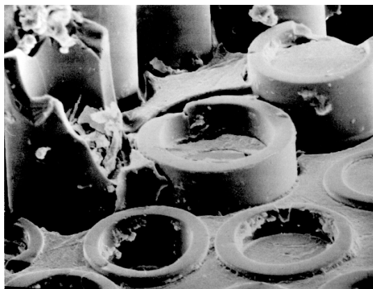
Abb. 3.8. Hohlglassfasern in einer Epoxidharz-Matrix (Quelle: DLR Braunschweig)
