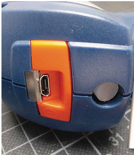
Orange: Ein/Aus-Taster und darin integriert die Buchse für das Ladekabel; darüber die LED Anzeige.
