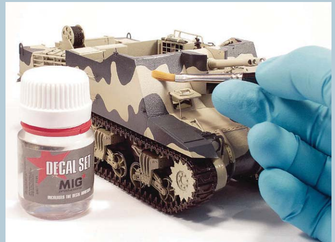
Der Ort, wo später das Decal platziert werden soll, wird mit einer Decalsetter-Flüssigkeit bestrichen.
