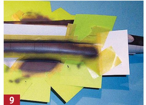
9 Die Abklebearbeiten für die Walkways sind zwar aufwendig, dafür aber nicht übermäßig kompliziert. Hier helfen „Hafties“.
