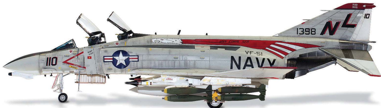
„Screaming Eagle 110“ – diese farbenfrohe F-4B der VF-51 vom Flugzeugträger USS CORAL SEA hat den Radarwarner AN/APR-30 unter dem Infrarotsucher am Bug anstatt vorn oben auf dem Seitenleitwerk. Das Original war von Farbausesserungen gezeichnet.
