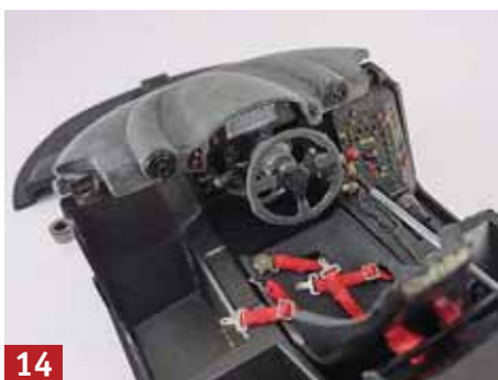
14 Carbon/Kohlefaser gilt als „schwarzes Gold“, da es sehr leicht und enorm stabil ist. Es wird mit Zweikomponenten-Harz verarbeitet.
