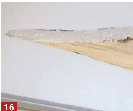
Dieser Styroporplattenausschnitt wird das gesamte Unterwasserschiff aufnehmen, so umgeht man das Zersägen des Rumpfes.
