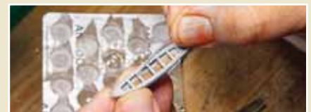
Sekundenkleber, von der Mulde eines Medikamentenblisters mit der Nadel aufgenommen und schließlich an die Klebestelle verbracht.
