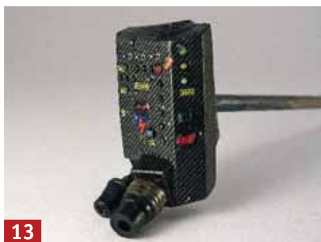
13 Sieht einfach aus, ist es aber nicht – das Aufbringen der Carbon-Decals gelingt wegen der Schalter nur mit viel Weichmacher.
