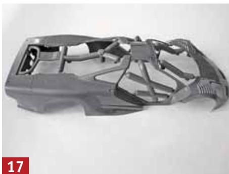
17 Bruchgefahr! Das Entfernen der massigen Gießäste, der aufwendig gestalteten Karosserie geschuldet, gelingt nur mit Sorgfalt.
