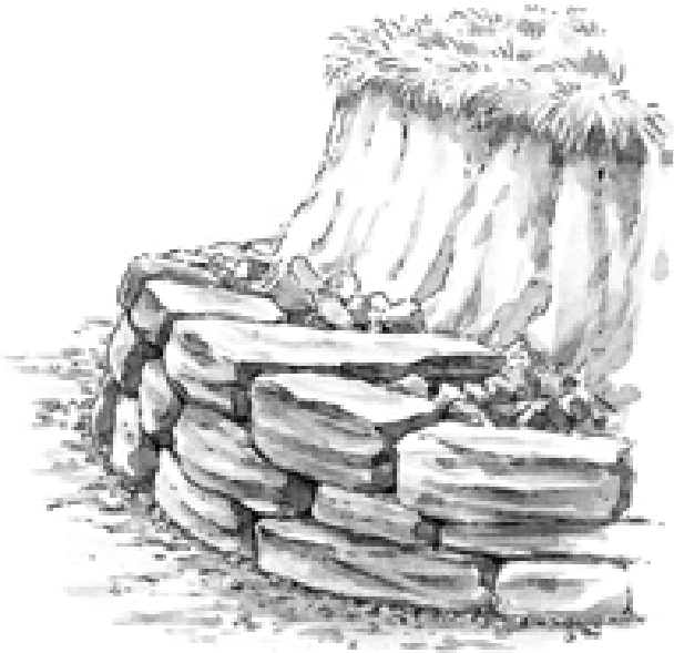
Lange Bindersteine verankern die Mauer im Erdreich und sorgen so für Stabilität
