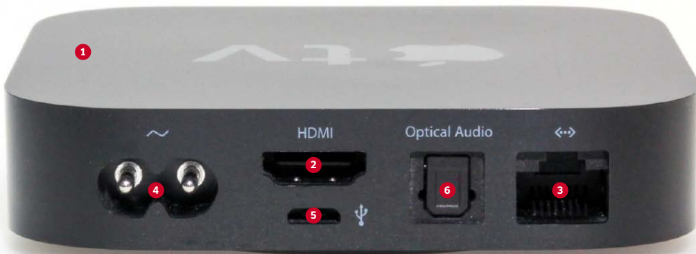
DIE ANSCHLÜSSE DES APPLE TV IN DER ÜBERSICHT 1 Im Gerät: Wi-Fi (802.11a/b/g/n) und Infrarot-Empfänger 2 HDMI 1080p 3 Ethernet (10/100Base-T) 4 Stromanschluss (6 Watt Universal-Netzteil) 5 USB-Anschluss für Service-Eingriffe 6 Optischer Tonausgang (Toslink)
