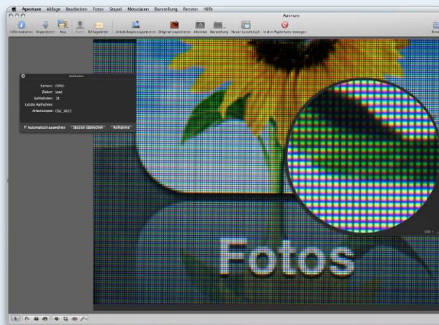
Retina-Display: Bei starker Vergrößerung wird die hohe Pixeldichte deutlich. Die Icons und Schriften erscheinen wesentlich detaillierter.
