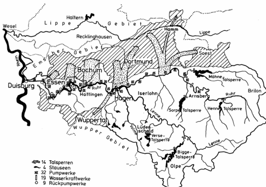
Abb. 1.2. Wasserlieferung über die Flussgebietsgrenzen der Ruhr; Betriebsanlagen des Ruhrtalsperrenvereins und des Ruhrverbandes nach [1.7]
