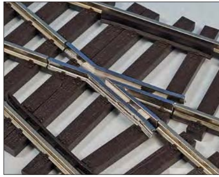
Wie gewohnt präsentiert sich das Herzstück mit den angedeuteten Füllstücken zwischen den Stegen der Gleisprofile.
