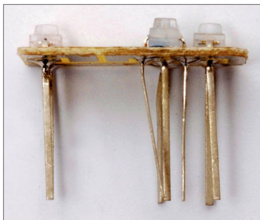
Seitenansicht der Hauptsignalplatine: Die LEDs werden mit abgewinkelten Beinchen bündig auf die Platine gelötet.
