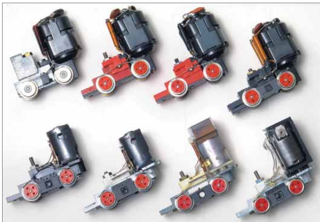
Übersicht der Antriebseinheiten der Egger-Bahn Fahrgestelle von 1963 (oben links) bis 1994. Adhäsionserhöhende Magnete sollten die Zugkraft verbessern, was jedoch nicht zielführend war. Fotos: Manfred Peter
