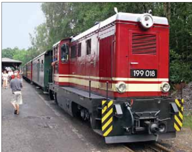
In Zittau setzt man eine L45H unter der Betriebsnummer 199 018 ein. Sie hat glatte Fronttüren mit breiten Luftschlitzen. Die Lok wurde im Stil einer DR-V 100 der Epoche III mit zwei Zierlinien lackiert (oben). Foto: Uwe Leirich
