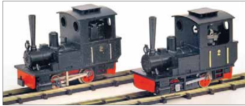
Die sichtbaren Produktionsvereinfachungen ab Mitte der 1960er Jahre betrafen Umlaufblech, Wasserkastendeckel, Griffstangen, Steuerungen und Kupplungen.
