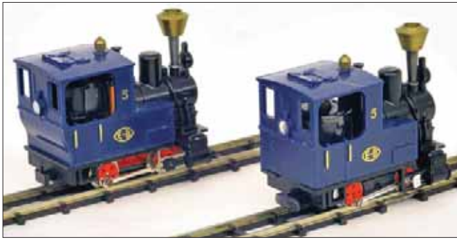
Beim Modell der Stainz wurde die vorbildorientierte Wölbung an der Rückseite aus fertigungstechnischen Gründen durch eine gerade Wandfläche ersetzt.
