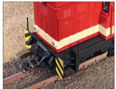
Die Trittstufe zum Umlauf wurde aus schwarz lackiertem Messingblech nachgebildet.
