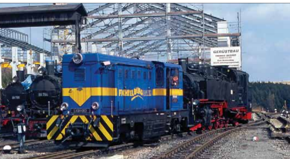
Ebenfalls mit den glatten Fronttüren ist L45H 358 der Löbnitzgrundbahn ausgestattet. Der kurze Vorbau (oben) besitzt keine Öffnungen in den Türen, die Türen im langen Vorbau haben großflächige Lufteinlässe. Fotos: MK
