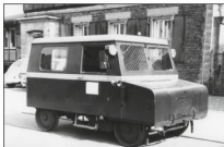
Viel Blech bildet den Vorbau der kantigen Variante des Bm-Klv, wie er 1956/57 in insgesamt 200 Exemplaren von FKF und Beilhack als Klv 12 4450ff gebaut wurde. Das schmale Rückfenster gestattet nur wenig Sicht nach hinten. Foto im April 1966 in Goslar: Reinhard Todt
