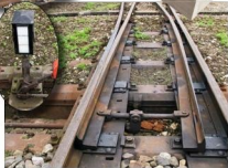
Der Weichenbock von mp-modellbau ist exakt nach Vorbild gefertigt. Für den kurzen Stellweg einer Schmalspurweiche muss er allerdings angepasst werden.
