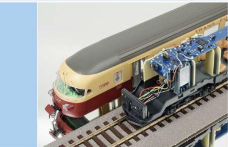
Angetrieben wird der TEE-Triebzug von einem Canon-Präzisionsmotor. Die Getriebe sind gekapselt und besitzen Messingbuchsen als Wellenlager.
