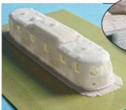
Die fertige Lok auf der Druckplatte. Der Ausdruck der E 19 offenbart die Schwachstellen des EX1: Die Oberfläche ist für detaillierte Modelle im H0-Maßstab nicht fein genug, die Riffelung zu grob.
