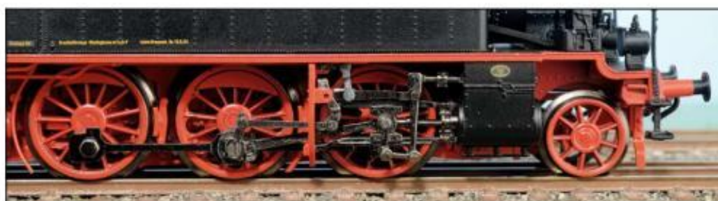
Das Fahrwerk der 75.1-3 zeigt an Laufrädern und Treibrädern unterschiedlich hohe Spurkränze. Die Steuerung besteht vollständig aus Metall.
