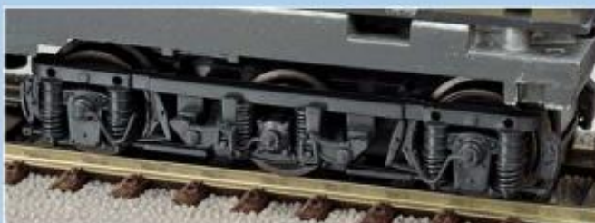
Vorbildgerecht hat der mittlere Radsatz des Maschinenwagens einen kleineren Durchmesser. Die Löcher dienen der Befestigung der Schürzeinsätze. Beachtenswert ist die hohe Plastizität.
