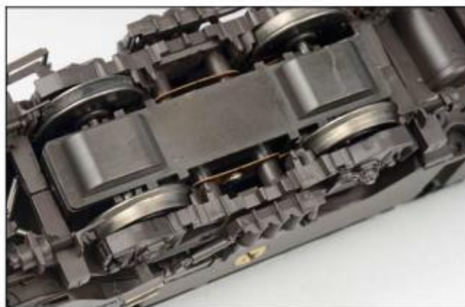
... getriebe auf beide Drehgestelle. Deren Bodenplatten sind mit jeweils vier Haltebügeln nur schwer zu entfernen. Foto: MK
