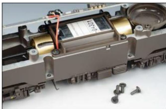
Unter der Hauptplatine liegt der Motor, der über zwei Schwungmassen verfügt. Er wirkt über Kardanwellen und Schnecken-Stirnrad- ...
