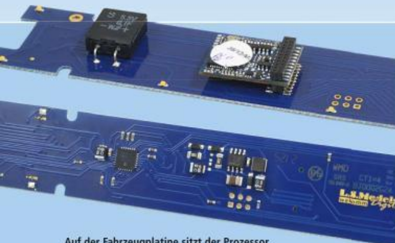
Auf der Fahrzeugplatine sitzt der Prozessor für den internen Zugbus, über den die komplette Steuerung erfolgt.
