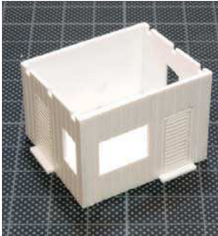
Die Wände der Außenschale des Postens sind verklebt. Zum rechtwinkligen Ausrichten diente die Grundplatte.
