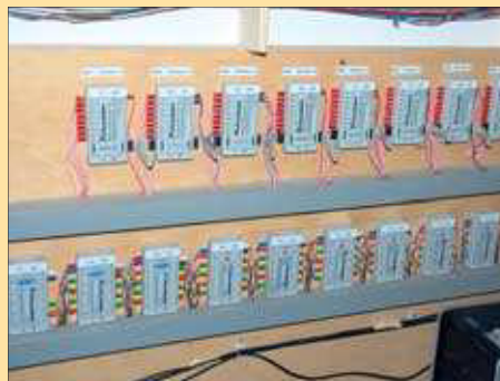
Sauber beschriftet: Die Uhlenbrock-Magnetartikeldecoder (oben) sind jeweils in der Nähe der Weichen oder Signale angeordnet.
