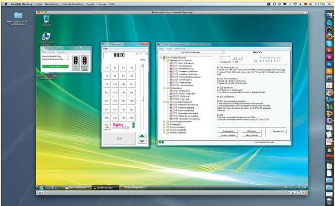
Dieses Bildschirmfoto zeigt das erste große Erfolgserlebnis: Windows Vista läuft als Gast unter OSX. Als Virtualisierungssoftware dient Parallels Desktop 5. Das Lenz-Interface ist erfolgreich angeschlossen, die Verbindung hergestellt. Das zeigt auch das kleine Fenster links „Lenz-LI-USB-Server“. In der Mitte steht das Fenster des LI-USB-Fahrreglers, über das sich erfolgreich Loks steuern ließen. Mit dem Programm CV-Edit (rechts) ließen sich die Parameter von DCC-Loks einstellen. Fotos und Illustrationen: Rainer Ippen
