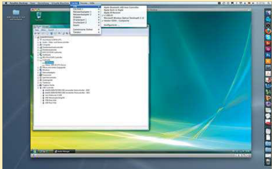
Windows Vista läuft als virtuelle Maschine unter Parallels Desktop 5 in einem eigenen Fenster. Im Windows-Gerätemanager sind sowohl das Lenz-USB-Interface als auch der USB-Stick mit den Lizenzdaten für den TrainController aktiv. Dass beide Geräte vom Host aktiv an das Gastsystem „durchgeschleift“ sind, zeigen die Häkchen im Gerätemenü von Parallels Desktop.
