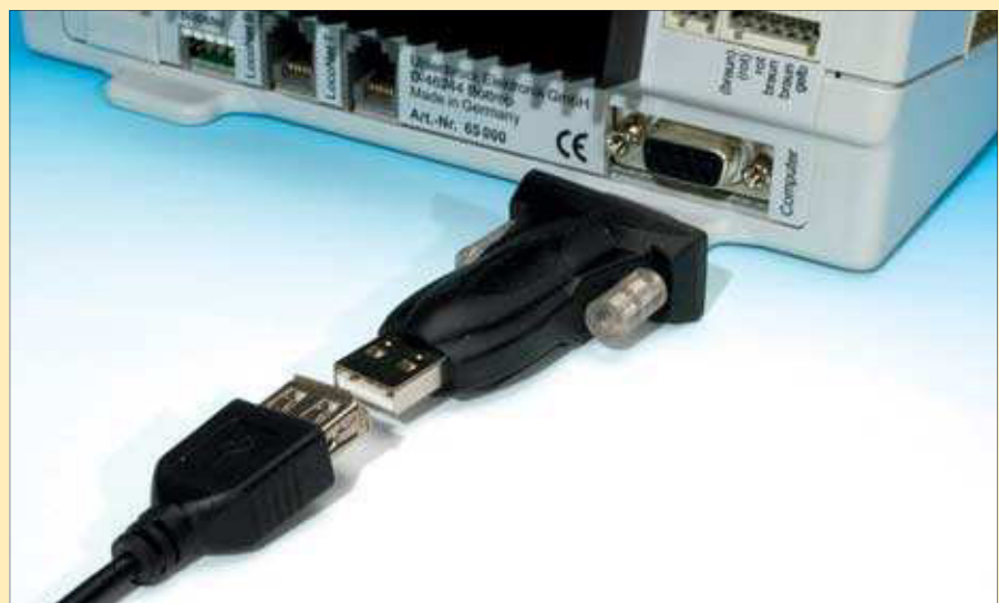
Ältere Geräte wie die Intellibox verfügen über eine COM-Schnittstelle mit RS232-Buchse zum Anschluss an den Computer. Mithilfe des Seriell-USB-Adapters gelang der Anschluss an den Computer. Solche Adapter gibt es in großer Auswahl mit Preisen zwischen 5 und 50 Euro.
