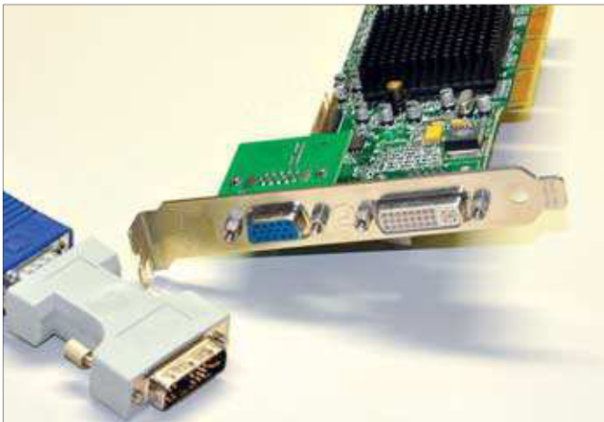
Die Matrox-Grafikkarte verfügt über zwei Ausgänge (analog sowie zum Anschluss eines Digitalbildschirms). Da hier zwei analoge Röhrenmonitore angesteuert werden sollen, muss der digitale Ausgang mit dem im Bild links sichtbaren Adapter angepasst werden.
