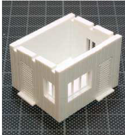
Zwei weitere Lagen Innenwände geben dem Gebäude im Bereich der Fensterlaibungen die notwendige Tiefe.
