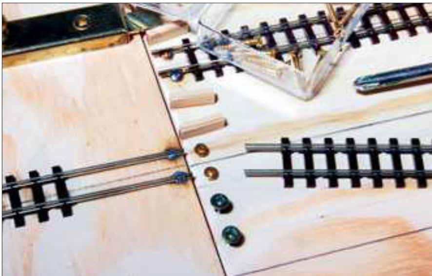
Bei der Montage der Gleise werden die Enden der Schienenprofile zur Erhöhung der Stabilität auf die Köpfe der zuvor eingebrachten Holz-Senkkopfschrauben gelötet.
