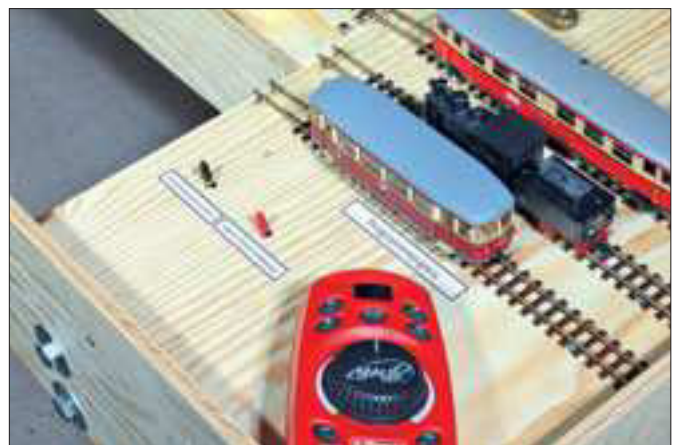
Eines der nichtbeweglichen Abstellgleise wurde als Programmiergleis vorgesehen. Es ist durch Schalter von allen anderen Gleisen trennbar. Die Schalterbeschriftungen erleichtern Gastfahrern die Bedienung des Fiddleyards.
