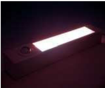
Der Sonnenaufgang zeichnet sich beim IntelliLight durch eine kräftige rote Beleuchtung aus. Diese wird durch eine der CCFL-Röhren erzeugt.
