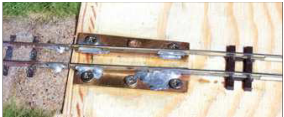
An die Stirnseite, an der sich der Gleisanschluss befindet, werden stabile Messingbleche geschraubt.
