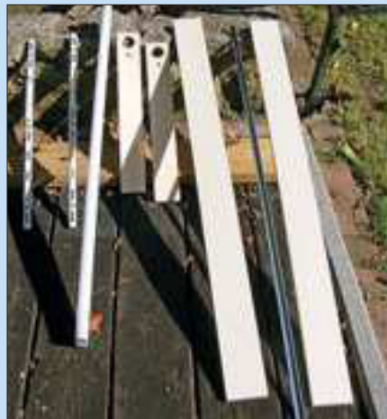
Hier sind bereits alle Teile des Beleuchtungssystems beieinander. Die beiden Regalträgerschienen dienen der Aufnahme der zwei Multiplex-Brettchen, die das einfache, aber stabile Beleuchtungssystem halten.
