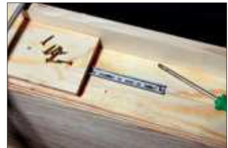
Die Gegenseiten der Schubladenführung werden passgenau an die Innenseiten des Fiddleyard-Rahmens geschraubt.
