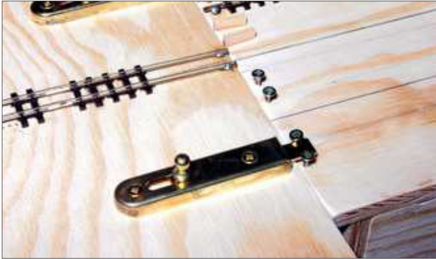
Um die Bühne bei der Überfahrt zu fixieren, werden Möbelriegel angebracht, deren Zunge zur Positionierung zwischen Schrauben oder Holz- oder Metallstücke geschoben wird.
