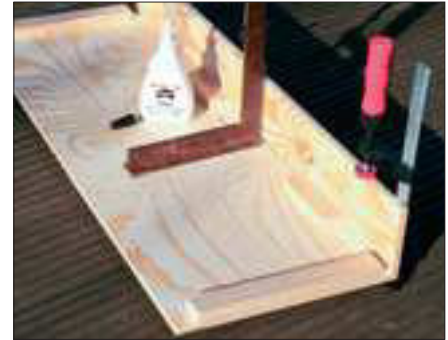
Rahmenwangen und Deckplatten werden anschließend verklebt und verschraubt. Zur Fixierung während des Leimens dienen Schraubzwingen.
