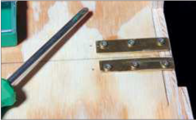
An die Stirnseite, an der sich der Gleisanschluss befindet, werden stabile Messingbleche geschraubt.
