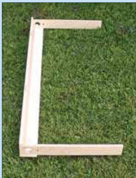
Oben: Die Beleuchtungskonstruktion der H0-Anlage „Landwitz-Hafen“ entstand aus leichtem, stabilem Multiplex-Material. Die beiden Bohrungen dienen der Aufnahme der Verkabelung.
