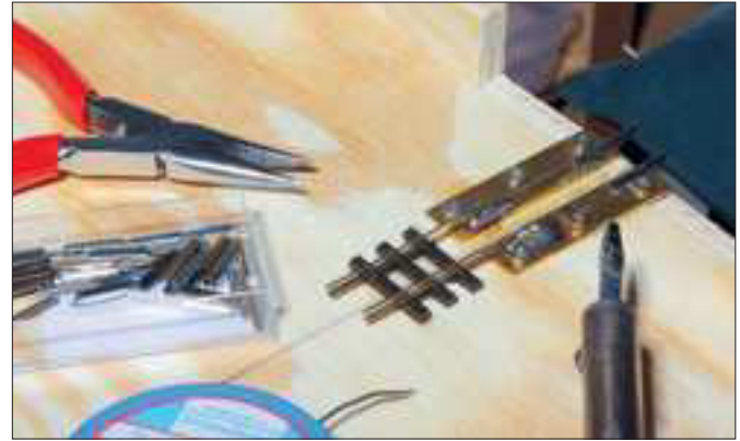
Auf die Bleche lötet man Schienenverbinder, in denen die Ausziehschienen leicht laufen.
