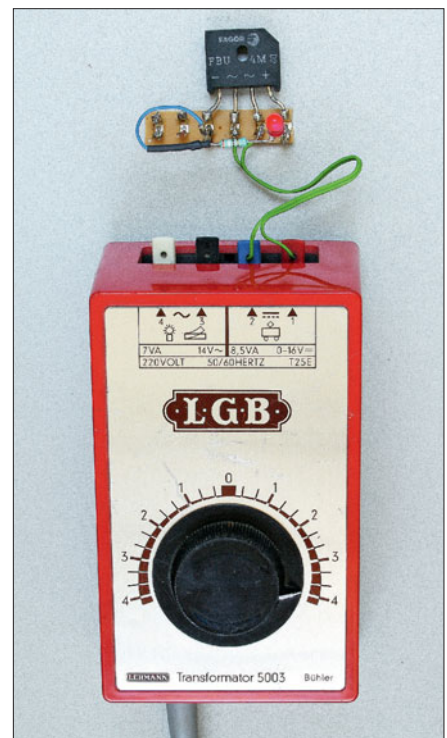
Ein Beispiel für Entkoppelndioden zur Fahrweganzeige in einem analogen Stellwerk. Erfolgt die LED-Versorgung mit DC, so fungiert die Diode am Eingang als Verpolungsschutz.
