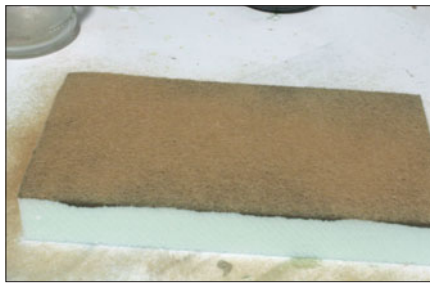
Auf den Kleber werden die Fasern aufgestreut.
