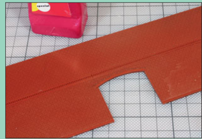
Als Urmodell entstand eine Wand mit großem Scheunentor, aus der später die Seiten- und Giebelwände gesägt werden.
