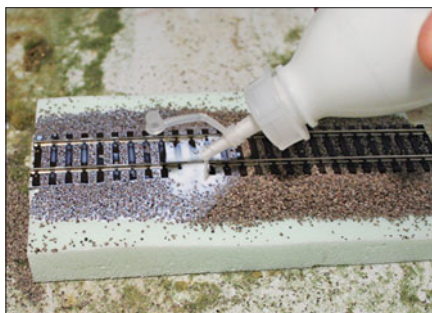
Ohne Anfeuchten zieht der Kleber in den Schotter.
