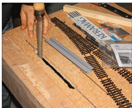
In die Anlagengrundplatte wird eine Öffnung für die Untersuchungsgrube eingearbeitet.
