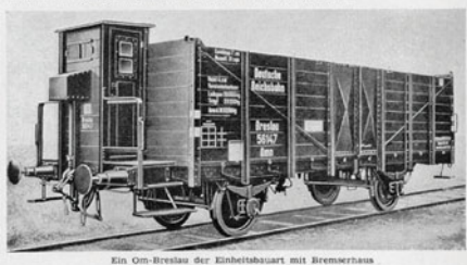
Ein Om-Breslau der Einheitsbauart mit Bremserhaus
