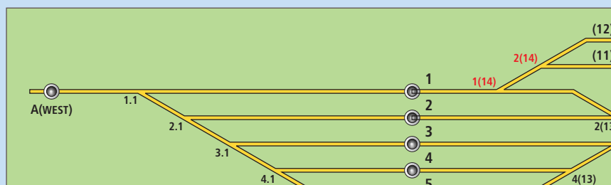
Bild 14. Dieser kleine Bahnhof mit fünf Gleisen braucht immerhin 12 Weichen. Er hat mehr Start-/Zieltasten (Gruppentasten) als Gleistasten. Man stellt Teilfahrwege, etwa: 1/A – 1/D für die Durchfahrt A–D bzw. D–A über GI 1. Wenn mich nicht alles täuscht, hat keine Schaltsequenz mehr als acht Schritte – Flankenschutz inklusive –, daher sind nur drei Sequenz-Adressen des EPROM erforderlich.
