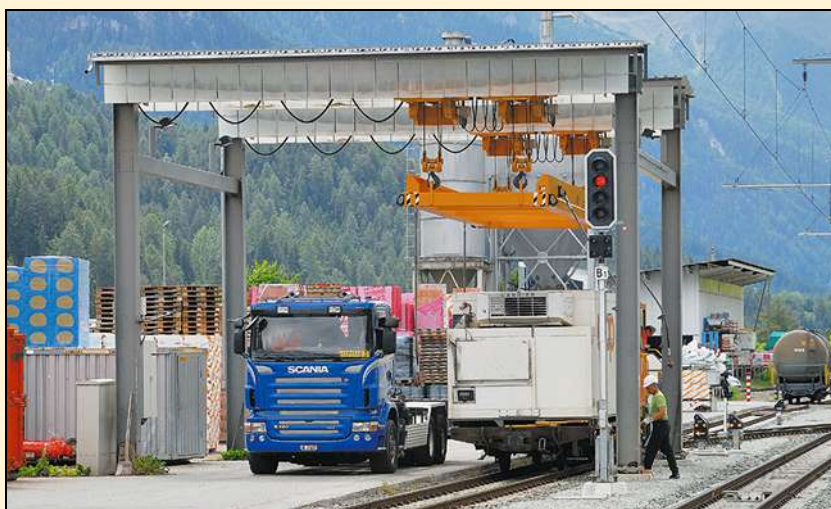
Nach der Position des Wagens unter der Krananlage werden die Trageile am Wechselbehälter befestigt und die Verladung kann beginnen.
