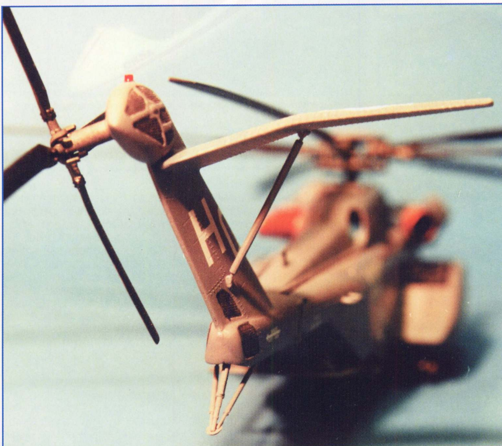
Das Heck knickt um 20° nach links ab, die Leitflosse wird durch einen weiteren Knick wieder in Fluchtlinie gebracht. Unten: Ein Blick auf die beiden Backbord-Turbinen, bei denen der Auslaß unterschiedlich ausgeführt ist.
