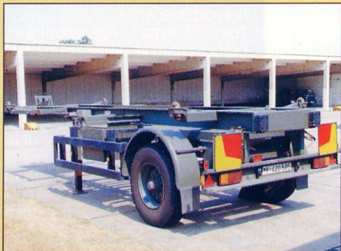
Fahrgestell Anhänger 1,5 t. Für diverse Rüstsätze, wie Mehrzweck und Transport nutzbar. HDS
