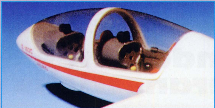
Das Haubenmaterial dürfte etwas dicker sein; hier kann es Probleme beim Zuschneiden und Einsetzen geben!
