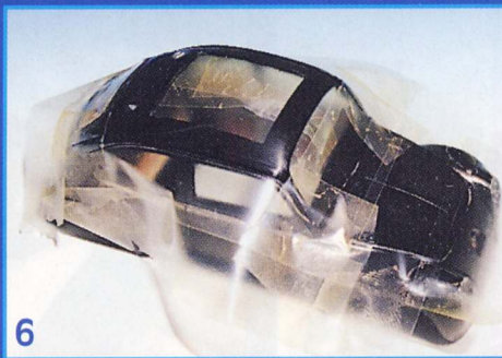
6 Die Karosserie wird großzügig abgeklebt
