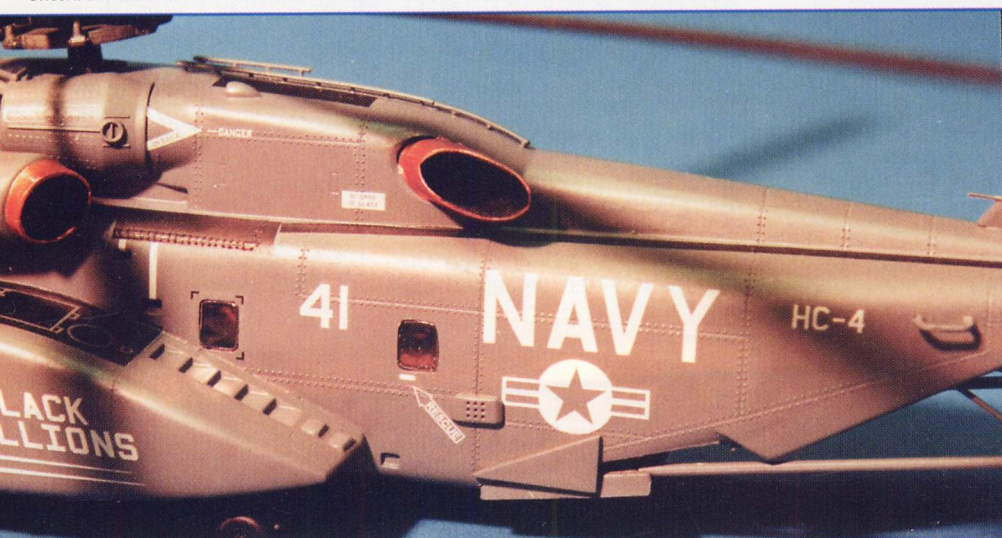
Das Heck knickt um 20° nach links ab, die Leitflosse wird durch einen weiteren Knick wieder in Fluchtlinie gebracht. Unten: Ein Blick auf die beiden Backbord-Turbinen, bei denen der Auslaß unterschiedlich ausgeführt ist.
