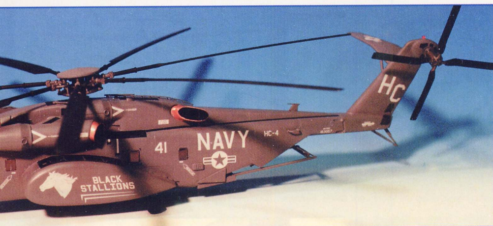
Das dritte Triebwerk wurde links hinter dem Rotormast eingebaut.
