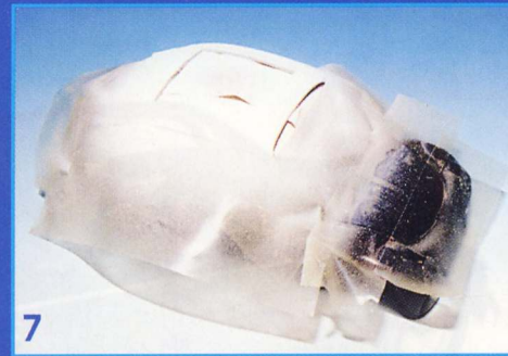
7 Als erste Farbschicht wird Weiß aufgespritzt
