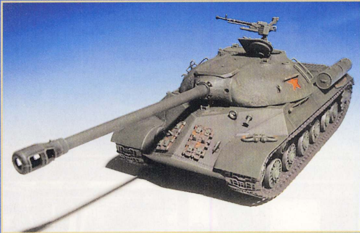
Die „elegante“ Erscheinung verdankt der Stalin III dem halbkugelförmigen Turm
