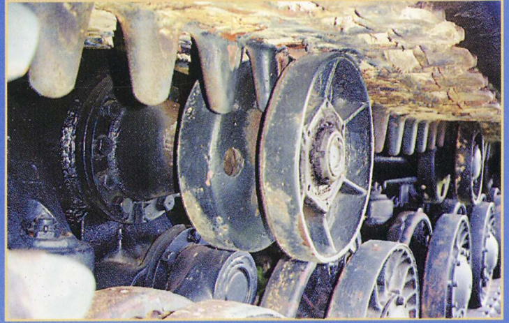
Stützrolle mit fehlender Schutzkappe
