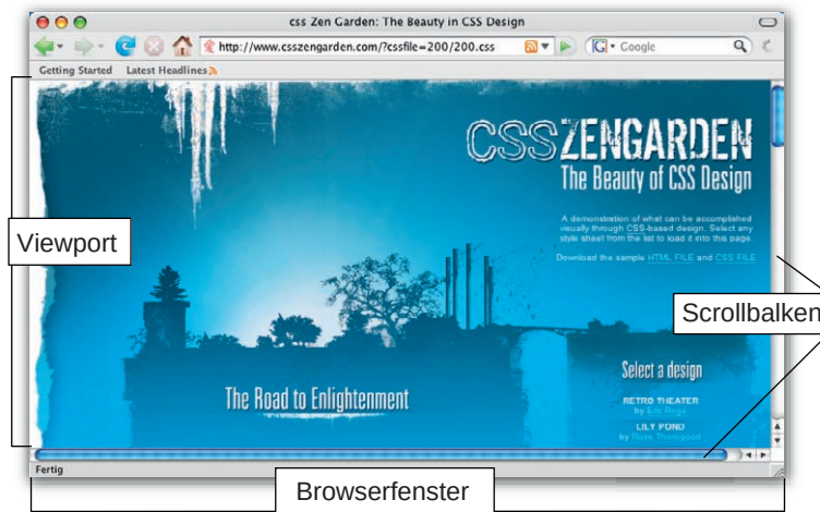
◀ Abbildung 2.31 Für die Betrachtung der Breite eines Layouts dürfen die Bestandteile des Browsers selbst – Viewport, Browserfenster und Scrollbalken – nicht vergessen werden.
