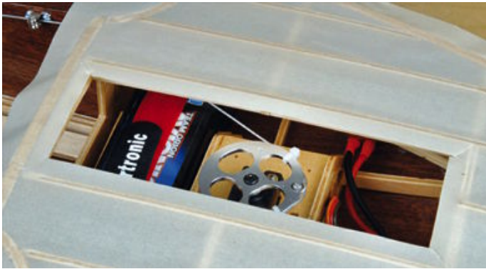
Nach dem Bügeln die Öffnung für die Zugangsluke freischneiden
