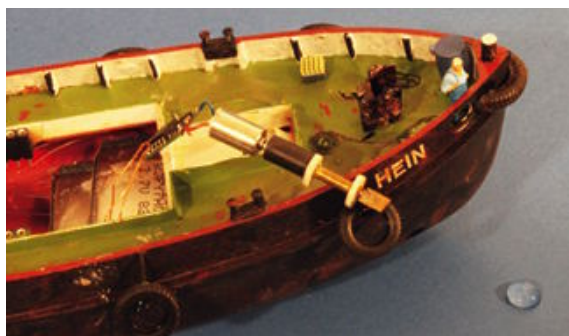
Das Bugstrahlruder besteht aus dem Motor und einem kleinen Paddel. Zur Wartung wird es einfach aus dem Rohr gezogen
