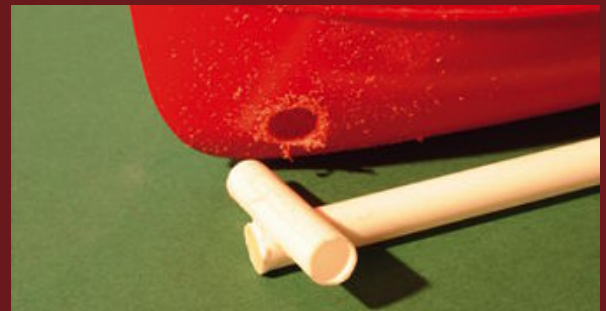
Aus zwei 6-mm-Evergreen-Rohren entsteht die Aufnahme des Bugstrahlruders
