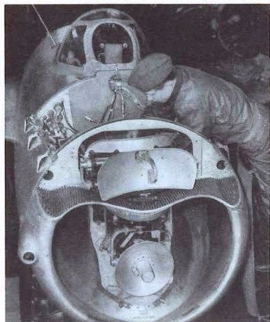
Unterbringung des Antennensystems der Funkmeßstation einer MiG-19
