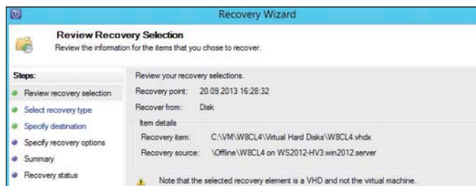
Bild 3: Beim Wiederherstellen von Daten ist auch der Restore von einzelnen VHD-Dateien möglich
