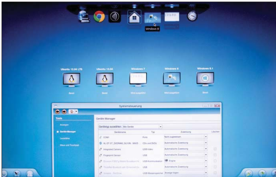
Bild 1: Über den Launcher werden die XenClient-Engine und die virtuellen Maschinen verwaltet. Das Dock am oberen Rand beherbergt lokale Anwendungen und führt zum Launcher zurück.
