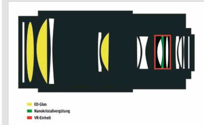
Schematische Darstellung eines Teleobjektivs mit VR-Einheit.
