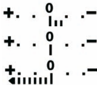
Anzeigen der Belichtungsskala: oben Unterbelichtung, Mitte exakte Belichtung und unten Überbelichtung. Die Teilstriche neben dem Nullpunkt geben die Unter- und Überbelichtung in 1/3 Lichtwerten an. Bei Anzeige des Pfeils beträgt die Fehlbelichtung mehr als 2 EV.
