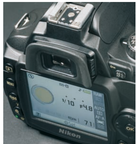
Die Nikon D60 mit Anzeige der Aufnahmeeinstellungen auf dem Kameramonitor.
