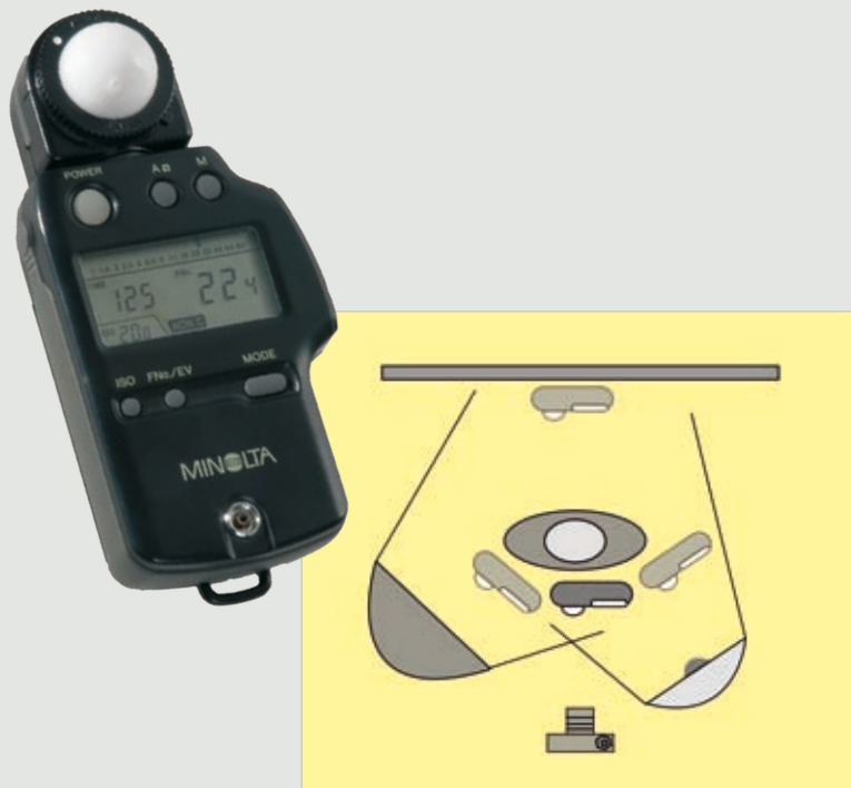
Handbelichtungsmesser mit Diffusorkalotte und seine Anwendung.
