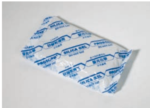
Silikagel nimmt Feuchtigkeit auf und schützt so die Kamera vor Kondenswasser.
