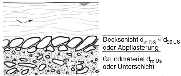
Abb. 3.10 Die Kornverteilung des Geschiebes entspricht in der Regel derjenigen der Unterschicht. Die Deckschicht ist gröber
