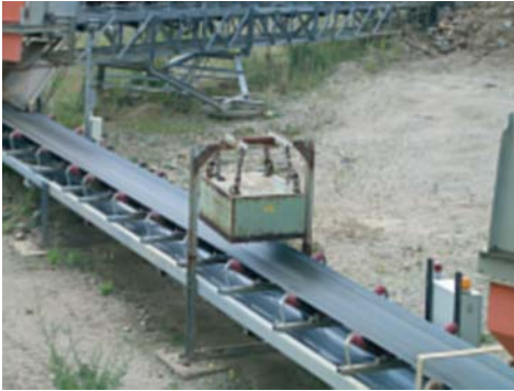
Abb. 6-27 Magnetabscheidung über Förderband
