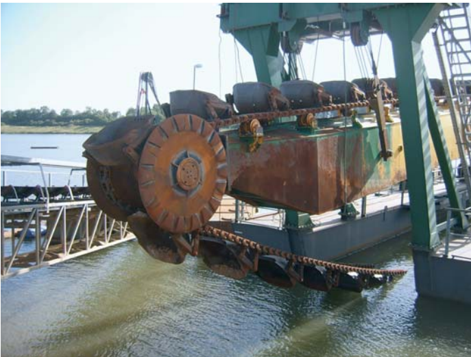
Abb. 5-59 Traktorkette mit Eimern für Nassgewinnung
