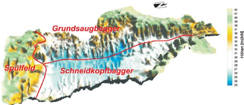
Abb. 3-15 Ergebnis einer Saugbaggerung in pleistozänem Quarzsand (im unteren Bereich erfolgte Baggerung mit einem Schneidkopfsaugbagger (ebene Sohlfläche), im oberen Bereich eine Grundsaugbaggerung mit Niederdruckwasseraktivierung des Saugkopfes (sehr unebene Sohlfläche))
