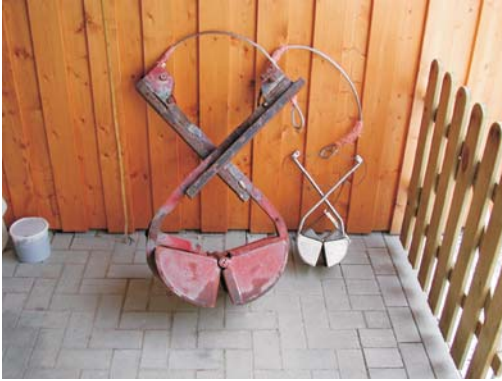
Abb. 3-25 Van-Veen-Greifer (Eingriffsfläche: l. 1.000 cm 2 , r. 250 cm 2 )
