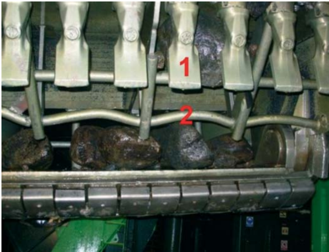
Abb. 5-28 Druckwasseraktivierter Schleppkopf für Mergelbaggerung (1: Meißel, 2: Druckwasserleitung)
