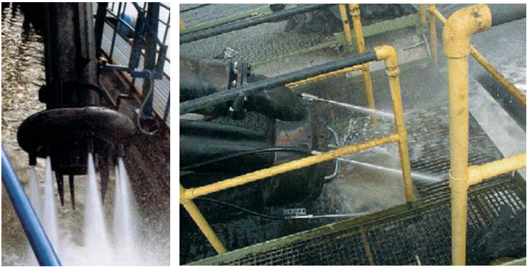
Abb. 5-39 Druckwasseraktivierter Saugkopf (l. diffuser Niederdruckwasserstrahl 172 , r. gerichteter Hochdruckwasserstrahl)
