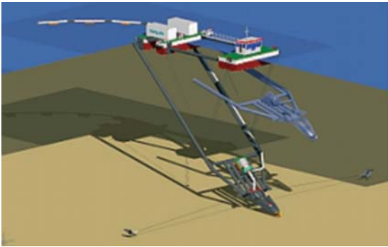
Abb. 5-38 Saugbagger für Kiessandgewinnung aus 100 m Tiefe
