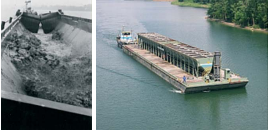
Abb. 5-77 Schuten in Kiessandgewinnung (l. Spalt-Klappschute, r. Siloschute mit Abzugsband)
