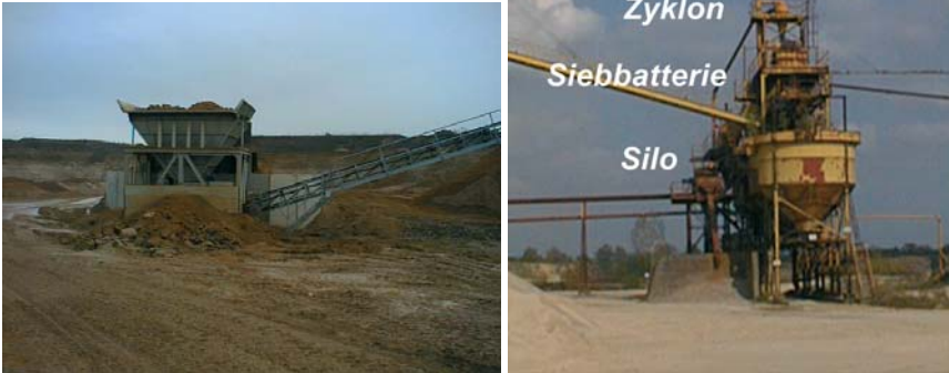
Abb. 6-2 Aufbereitung eines Rohsandess ohne Fraktionierung mittels l.: Grobabscheidung aus Sandvorkommen; r.: Kreisschwingsieb über Silo
