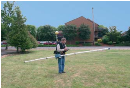
Abb. 3-61 Einsatz elektromagnetischer Induktionsverfahren im Gelände. (l. Geonics EM 31, r. EM 34-3) 108
