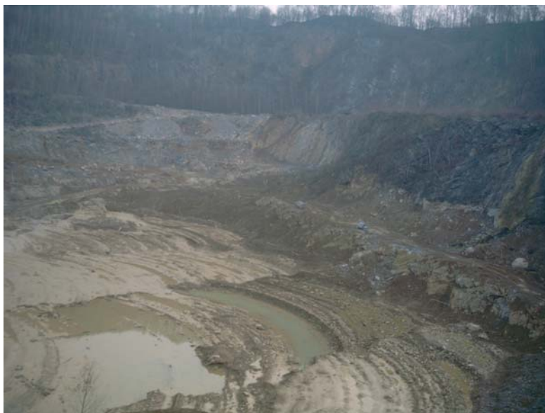
Abb. 5-49 Abbauspuren eines Schneidkopfsaugbagger in einem Tagebau nach Abpumpen des Wassers 180
