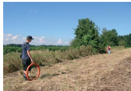
Abb. 3-61 Einsatz elektromagnetischer Induktionsverfahren im Gelände. (l. Geonics EM 31, r. EM 34-3) 108
