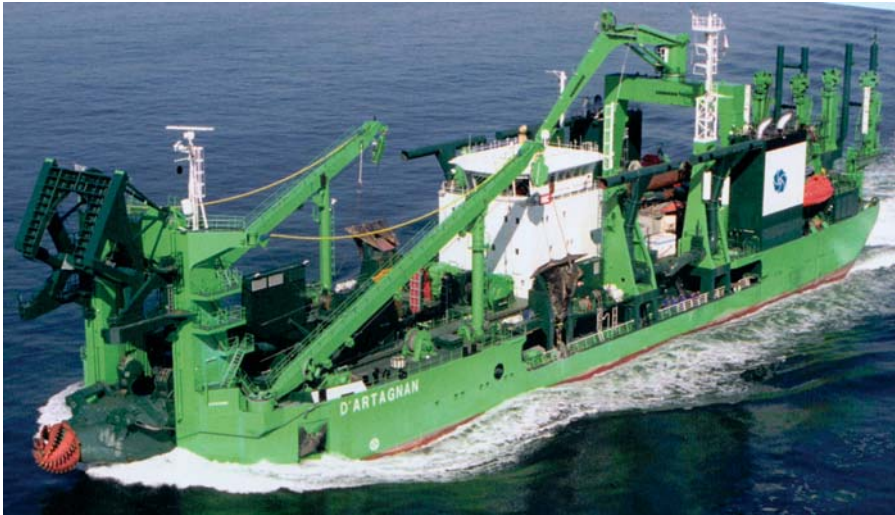
Abb. 1-8 Moderner Fels- Schneidkopfsaugbagger d'Artagnan 6
