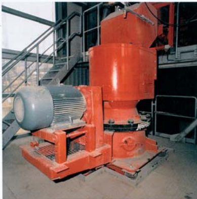
Abb. 6-28 Prallmühle zur Zerkleinerung von Überkorn > 32mm
