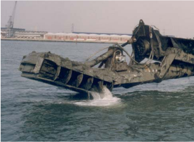
Abb. 5-17 Baggerung von auflagerndem Ton und Schluff mittels LTD
