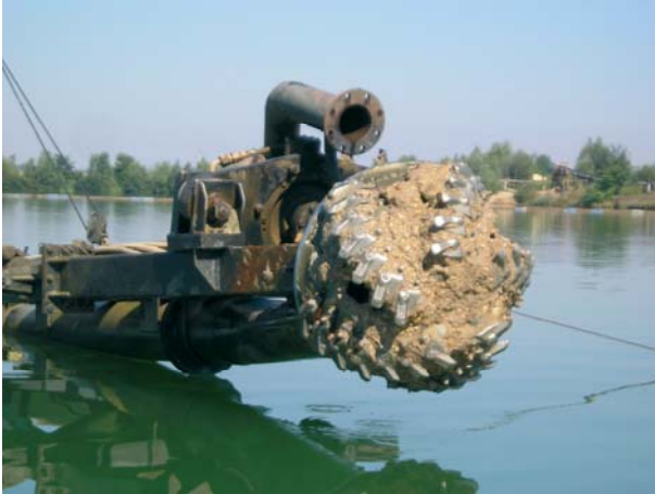
Abb. 3-12 Mit bindigem Boden zugesetzter Schneidkopf
