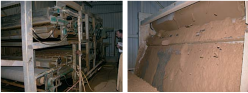
Abb. 6-26 Siebbandpresse (Filtration von Prozesswasser) links und Filterkuchen rechts
