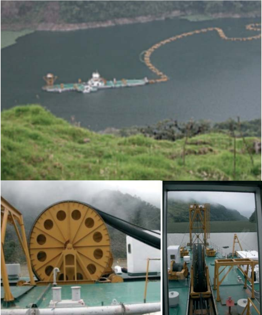
Abb. 5-43 Japanischer Tiefsauger mit Unterwasserkreiselpumpe und flexibler Saugleitung bei Unterhaltungsbaggerung in einer Talsperre (Baggertiefe bis zu 100m)
