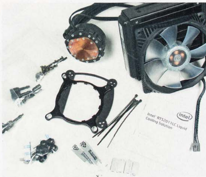
Im Bild zu sehen ist der komplette Lieferumfang der Intel-Wasserkühlung für die Sockel 1155, 1156, 1366 und 2011. Für AMD-Systeme ist das Produkt ungeeignet.
