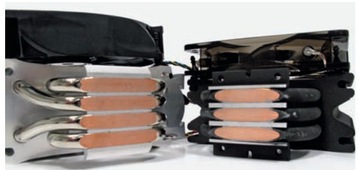
Die Xigmatek-Kühler nutzen beide „Direct Touch“, die Heatpipes liegen direkt auf dem Heatspreader auf. Beim Prime SD1484 ist die Kontaktfläche deutlich größer.
