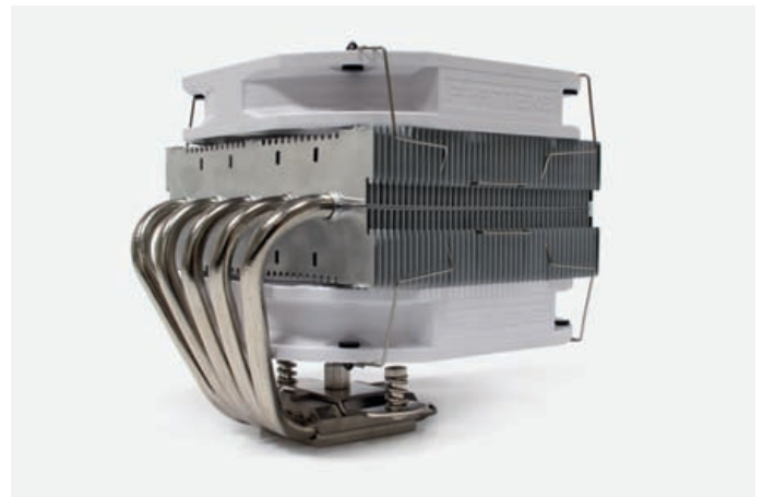
Der Testsieger Phanteks PH-TC14CS: Der Top-Flow-Kühler hat fünf 8-mm-Heatpipes, die die Abwärme zu den Aluminiumlamellen führen.
