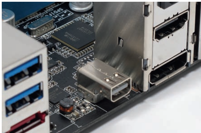
Die Form des Thunderbolt-Anschlusses gleicht einem Mini-Display-Port, braucht aber andere Kabel. Im Hintergrund erkennbar: der Thunderbolt-Controller-Chip von Intel.
