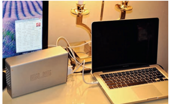
Beim GUS II (Graphics Upgrade Solution II) von MSI handelt es sich um ein externes Gehäuse für Grafikkarten, das per Thunderbolt angeschlossen wird. Termin: ungewiss.
