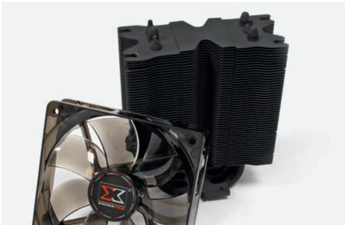
Der Dark Knight SD 1283 ist von einer mattschwarzen Keramikschicht bedeckt. Der LED-bestückte Lüfter ist mit bis zu 4 Sone der lauteste im Test.
