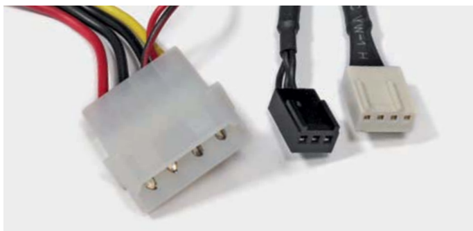
Im Bild sehen Sie die aktuell üblichen Anschlussmöglichkeiten: Molex, 3-Pin und 4-Pin-PWM. Die beiden Letzteren eignen sich deutlich besser für eine Regelung.
