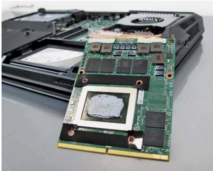
Eine schnelle mobile Grafiklösung sind Steckkarten in MXM-Bauweise (Mobile PCI Express Module); sie benötigen bis zu 100 Watt. Im Bild ist eine GTX 570M zu sehen.
