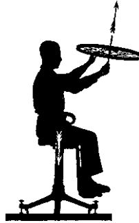
Abb. 102. Zur Erhaltung des Drehimpulses. Die Pfeile zeigen die Drehimpulse von Rad und Experimentator an. (Bei kleinen Winkelgeschwindigkeiten wird man durch Reibung gestört.) (Videofilm 16)
