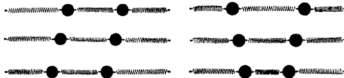
Abb. 272. Je drei Momentbilder von Longitudinalschwingungen zweier gekoppelter Federpendel. Oben und unten im Zeitpunkt großer Ausschläge, in der Mitte beim Passieren der Ruhelage. — Links schwingen beide Körper mit gleicher Phase, rechts hingegen um 180^\circ gegeneinander phasenverschoben.
