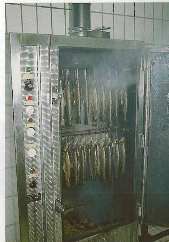
Räucherschrank aus hochwertigem Edelstahl mit guter Isolierung.
