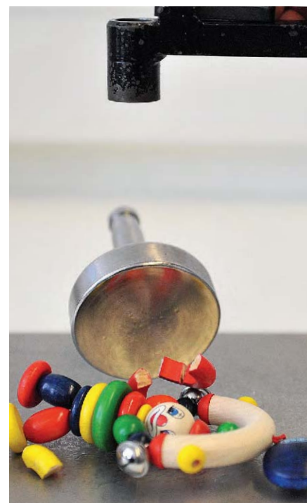
Schlagprüfung. Die Metallscheibe fällt aus zehn Zentimetern Höhe auf den Holzring. Er zerbricht in Kleinteile, die Kinder verschlucken könnten.
