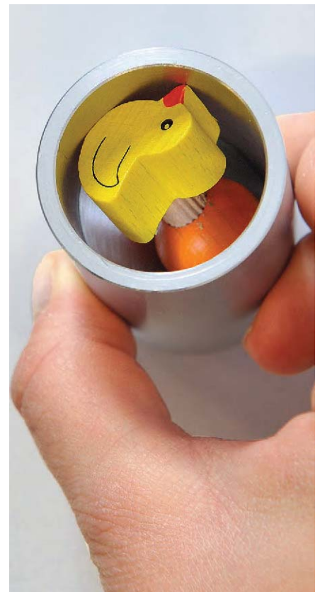
Prüfzylinder. Teile, die hier hineinpassen, könnten Kinder verschlucken.
