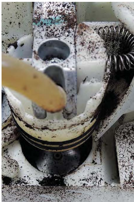
Kehrseite eines Vollautomaten. Kaffeereste im Gehäuse. Beugen Sie vor, nutzen Sie Spül- und Reinigungsprogramm.
