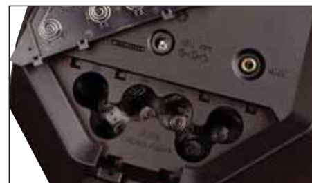
Das Batteriefach fasst sechs handelsübliche AAA-Batterien oder Akkus
