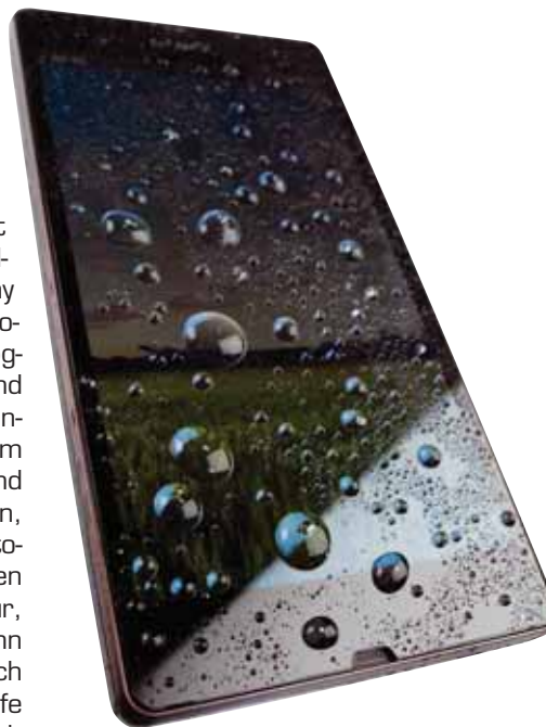
Das Gehäuse des Xperia Z ist gut gegen Spritzwasser und Staub geschützt
