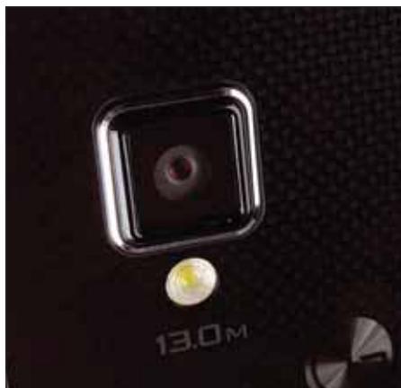
Auch LG mutet dem Sensor satte 13 Megapixel zu, die müssen dann eben entsprechend klein sein
