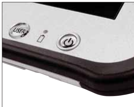
Die wenigen Hardkeys sind ebenfalls gegen Eindringen von Wasser und Staub gefeit
