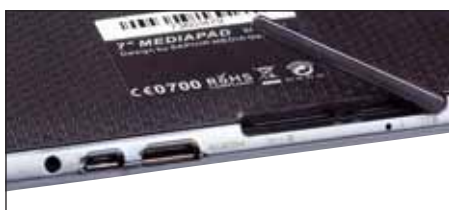
SIM- und microSD-Karte befinden sich sicher unter einer Abdeckung
