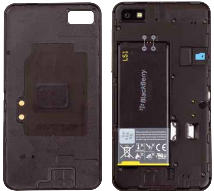
Unter dem Deckel befinden sich Wechselakku und die Schächte für SIM- und Speicherkarte. Im Deckel gut zu erkennen: der Chip für die NFC
