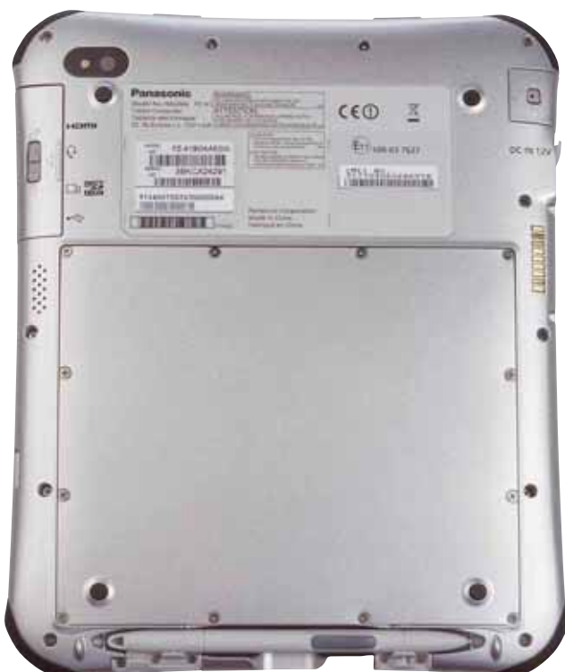
Unter dem großen Deckel mit den vielen Schrauben befindet sich der Akku, der bei Bedarf ausgewechselt werden kann
