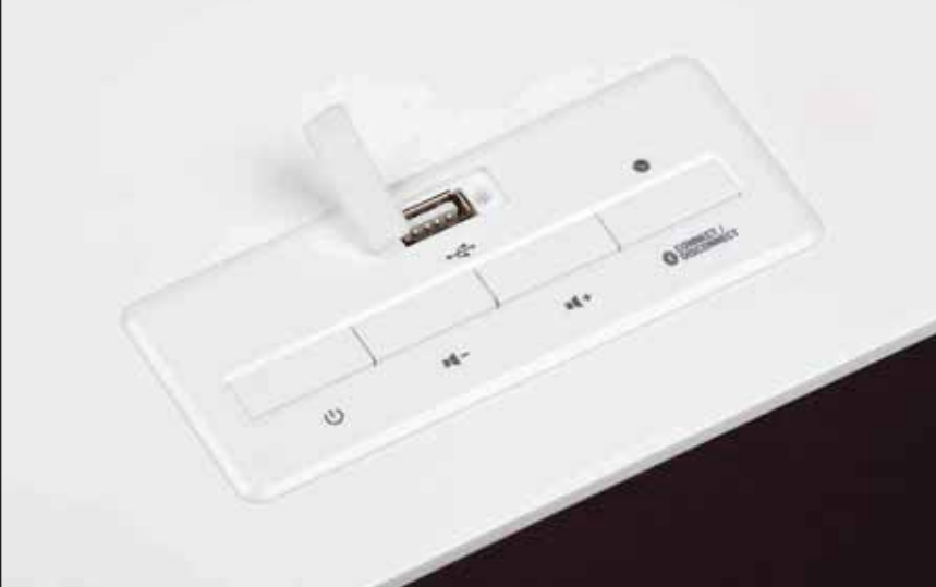
Die USB-Schnittstelle dient zum Aufladen der Mobilgeräte, die dafür vorgesehen sind; sie ist mit einem Deckel gegen Staub geschützt
