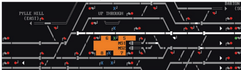
Durchrutschweg zur Vermeidung eines Ausschlusses in anderes Gleis gewechselt
