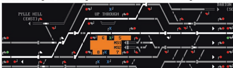
Durchrutschweg zur Vermeidung eines Ausschlusses in anderes Gleis gewechselt
