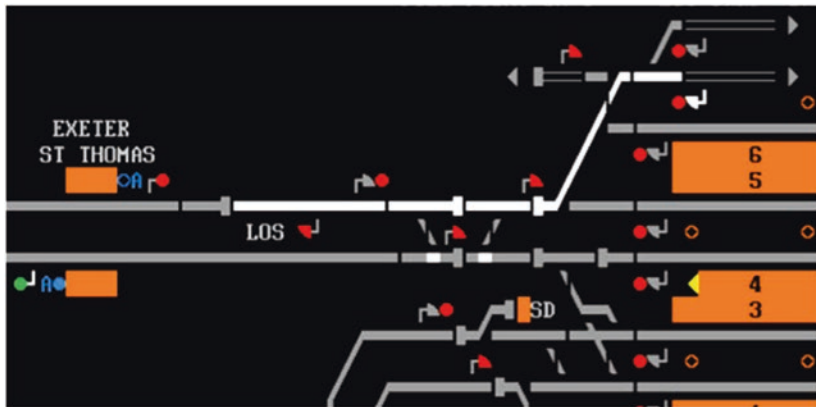
Abb. 2.4 Limit of Shunt Signal auf der Bedienoberfläche in einer Betriebszentrale (Stellwerkssimulation von www.simsig.co.uk )
