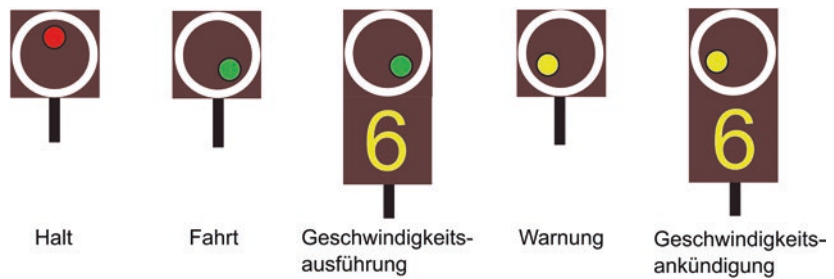
Abb. 5.6 Grundlegende Signalbegriffe im Schweizer System N
