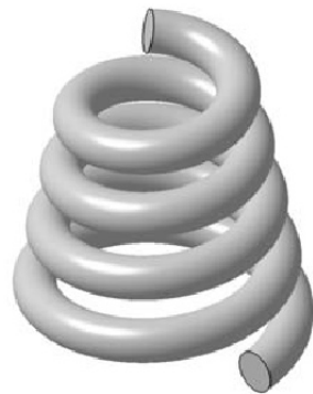
Eine Schraubenfeder mit abweichender Helix als Zentralkurve
