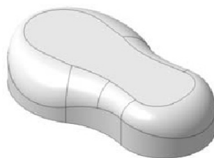
Volumenkörper mit einer Abstandsverrundung
