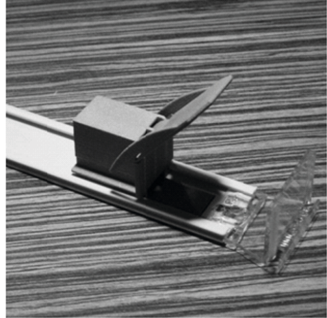
Abbildung 2.12 Vorschub mit klappbarer Schublade ermöglicht Platzierung von 2 Trays hintereinander
