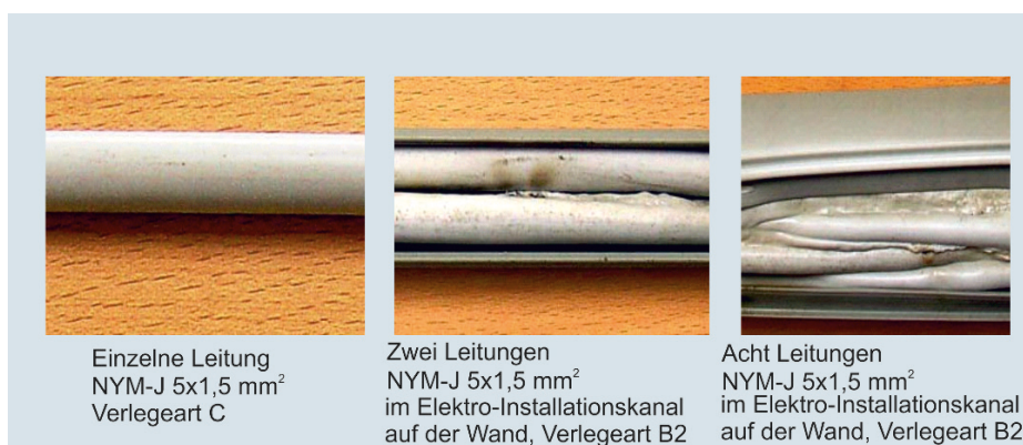
Bild 21.8: Überbelegung einer Kabeltrasse [45]
