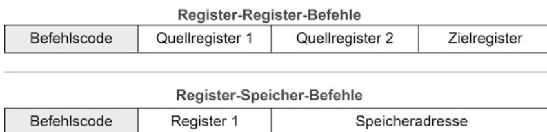
Abb. 4.21 Befehlsformate für die zwei Klassen von Befehlen
