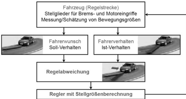
Abb. 3.5 Prinzipielles Blockschaftbild der Fahrdynamikregelung [REI-10]
