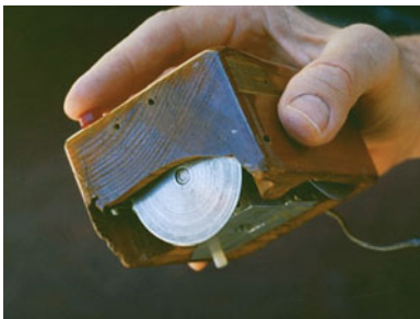
Abb. 196 a–c Douglas C. Engelbart und William English entwickelten 1963–64 am Stanford Research Institute (SRI) den »X-Y-Positions-Anzeiger für ein Bildschirmsystem« im Zusammenhang mit Untersuchungen, wie man das Zeigen und Auswählen einzelner Elemente auf einem Bildschirm ermöglichen kann.
