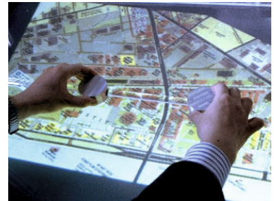
Abb. 251 Passive Lense und Phiton des metaDESK.
