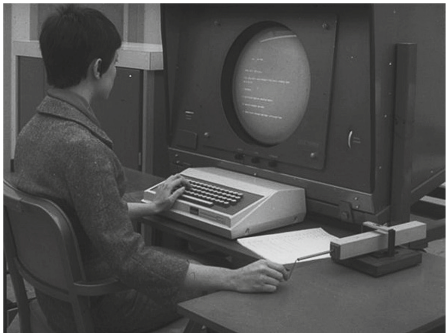
Abb. 195 Mit dem Graficon, einem experimentellen Eingabegerät aus dem Jahr 1963–64, wird die Suche nach geeigneten Methoden deutlich, mit denen man auf die am Bildschirm abgebildeten Inhalte eingreifen kann.
