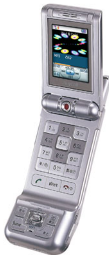
Abb. 206 Der Joystick oder entsprechende NavigationsKeys bieten sich bei mobilen Geräten zur Steuerung an, da diese in der Regel mit dem Daumen bedient werden. Das Mobiltelefon Samsung SCH-V450 macht beide Möglichkeiten sehr gut deutlich.
