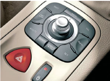
Abb. 202 Der Joystick im Renault Espace Laguna kann zusätzlich zu den Richtungen auch in Rotation bewegt werden und bietet durch sein Drehrad zahlreiche weitere Funktionsmöglichkeiten.
