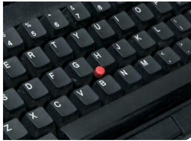
Abb. 203 IBM bietet die Tastaturen M13 mit Joystick an, der hier Track-point genannt wird (siehe roter Punkt).
