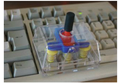
Abb. 204 Da sich die Pfeiltasten der Computertastatur und auch die Anordnung der meisten numerischen Tastaturen der Mobiltelefone als Navigations-Keys eignen, lag es nahe, einen Joystick-Aufsatz zu entwickeln. Der Microsoft SideWind Turbo Joystick harmonisiert mit jeder bei Microsoft erhältlichen Hard- und Software.
