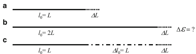
Abb. 2.20 Zur Einführung logarithmischer Dehnungen
