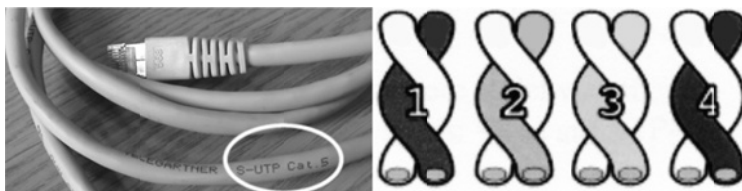
Abbildung 4.20: Aktuell verwendet man ein TP-Kabel der Kategorie 5, welches aus vier verdrehten Leitungspaaren besteht.
