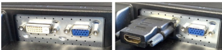
Abbildung 1.9: Dieser Monitor verfügt über zwei Anschlüsse, wobei die DVI-Buchse mit einem Adapter (rechts) auf eine HDMI-Buchse umgesetzt werden kann.
