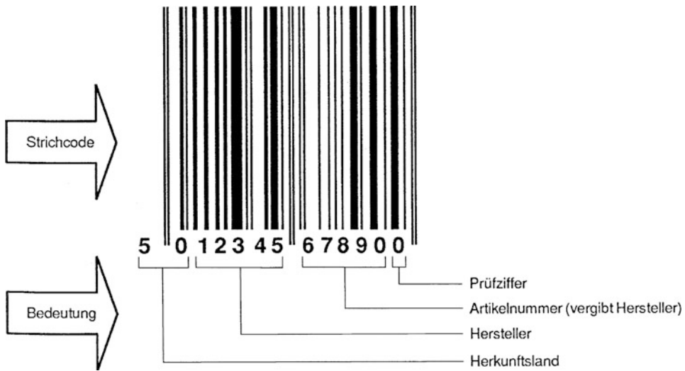
Abb. 5.71 Aufbau eines EAN-Codes
