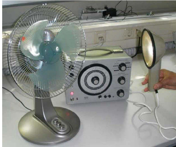
Abb. 3.10: Messung der Rotationsgeschwindigkeit eines Ventilators mit einem Stroboskop
