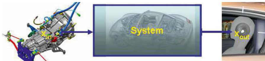
Abb. 1.5: Übertragungsweg von Getriebegeräuschen (hier Luftschall) als System
