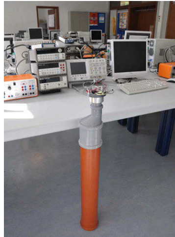
Abb. 5.58: Prinzipielle Darstellung der Versuchsanordnung zur Volumenmessung (links) und Realisierung als Laborversuch (rechts)
