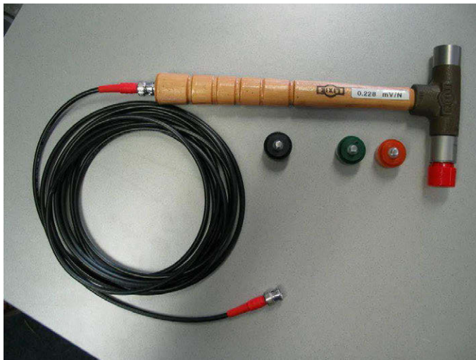
Abb. 2.15: Impulshammer zur Identifikation mechanischer Systeme [12]
