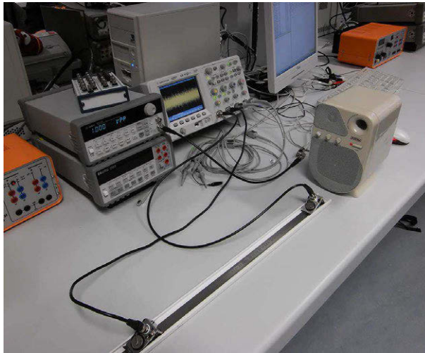
Abb. 5.47: Versuchsaufbau des Messsystems zu Abstandsmessung
