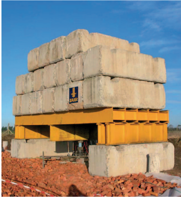
Abb. 3.2 Statischer Pfahltest. (Bild: Fa. Bauer)
