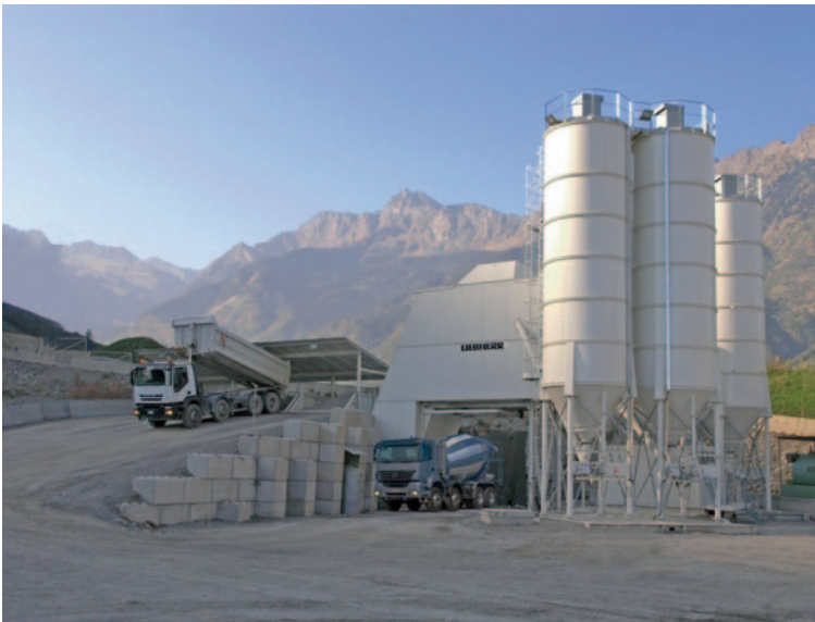
Abb. 3.6 Betonmischanlage Mobilmix 2,25. (Bild: Liebherr)
