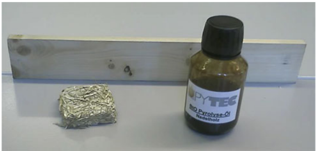
Abb. 9.6 BtL-Pyrolyseöl (Dichte 0,76–0,79 kg/l, Brennwert 43,9 MJ/kg, CZ > 70)
