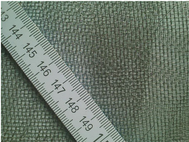
Abb. 12.16 Drahtgeflecht als Regeneratormaterial
