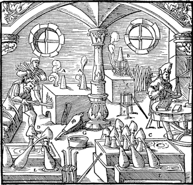
Abb. 2.3 Scheidung von Gold und Silber mittels „Scheidewasser“ (Mitte 16. Jahrhundert). (Gemeinfrei)
