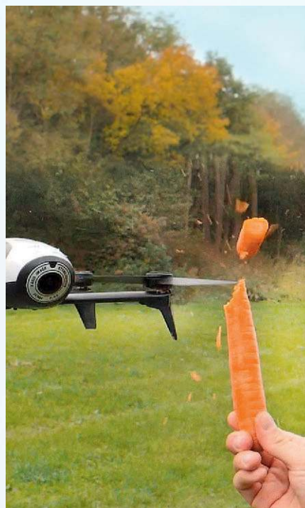
Verletzungsgefahr. Der Rotor einer Drohne schnippelt Karotten in Stücke. Im Finger gäbe es tiefe Wunden.
