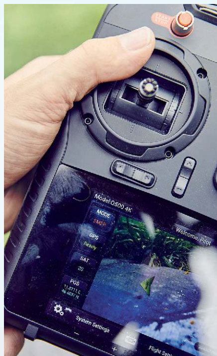
Fernbedienung. Das Display zeigt Bilder der Drohnenkamera. Manche Modelle verwenden den Smartphone-Bildschirm.
