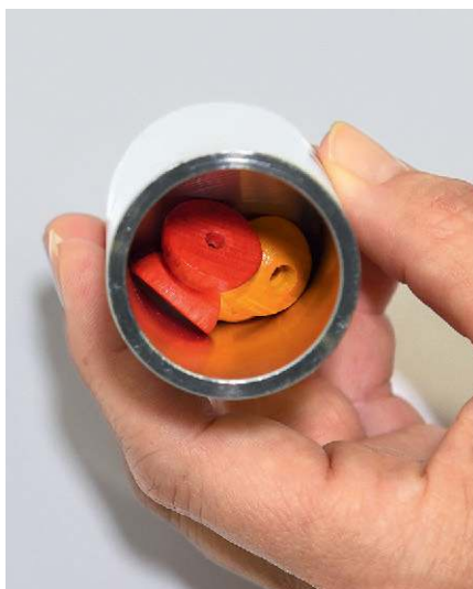
Prüfzylinder. Was in den Zylinder hineinpasst, können Kinder verschlucken.
