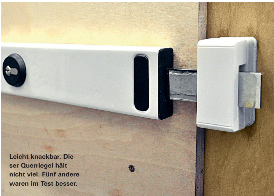
Versagt. Der Schließkasten ist ein schwaches Bauteil des links gezeigten Riegels.
